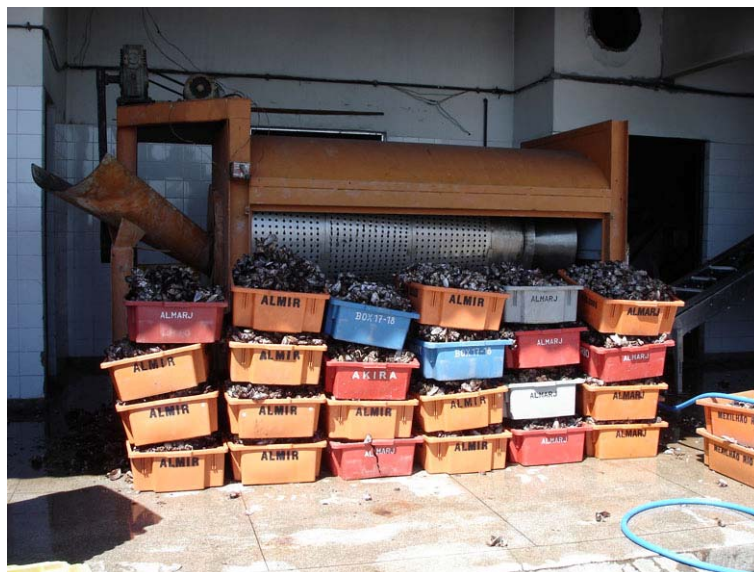
Figura 19 – Máquina de lavagem e separação dos mariscos no fundo da ALMARJ com as caixas resultantes do trabalho dos marisqueiros. Foto da autora.
